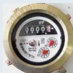
水道メーター
