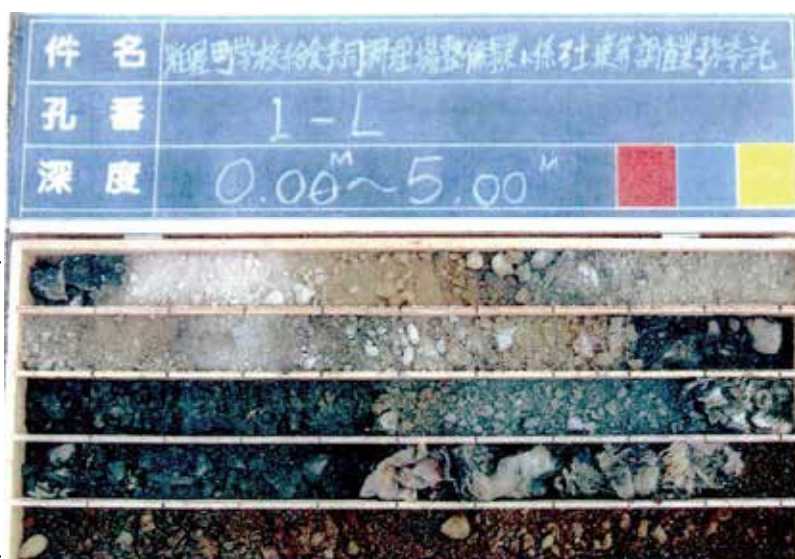
給食センター地盤調査柱状図地表下5mの写真（一区画）
